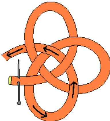
3. Eine dritte Schlinge bilden, indem der Schlauch durch die beiden vorhandenen Schlingen durchgesteckt wird. Dabei darf sich der Schlauch nicht verdrehen.
