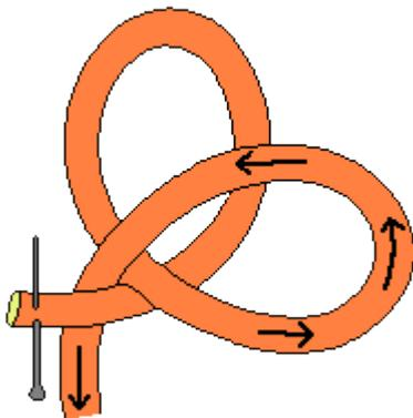
2. Den Schlauch ein zweites Mal über die Schlaufe schlingen und unter dem Ende durchstecken. Die Schlauchnaht muss stets nach unten liegen.
